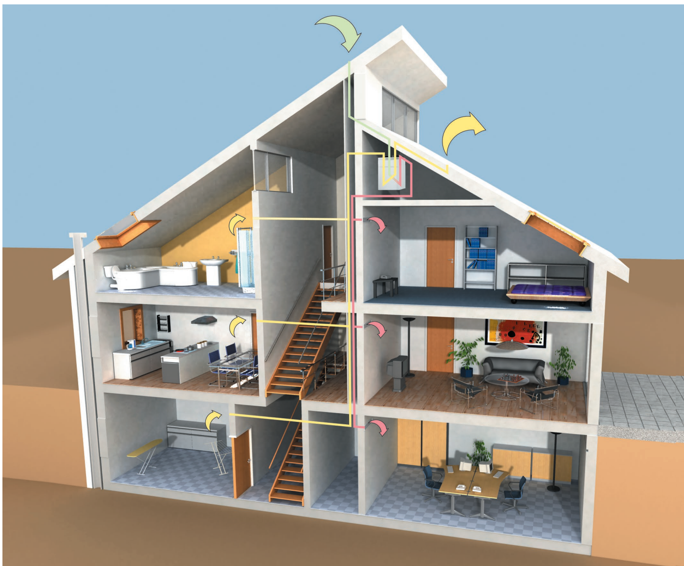
Princip systému recoVAIR
