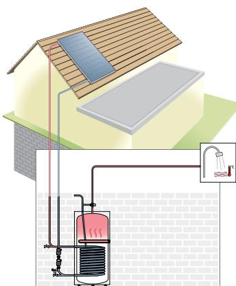
Hydraulické schéma auroSTEP ISS - monovalentní zásobník
