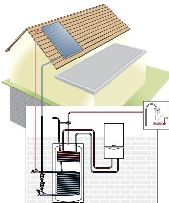
Hydraulické schéma auroSTEP ISS - bivalentní zásobník
