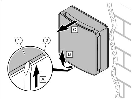
3. Irrota puhallinyksikkö (1) (sis. tuulensuoja ja etusuojus) seinäkiinnityskehystä (2).
