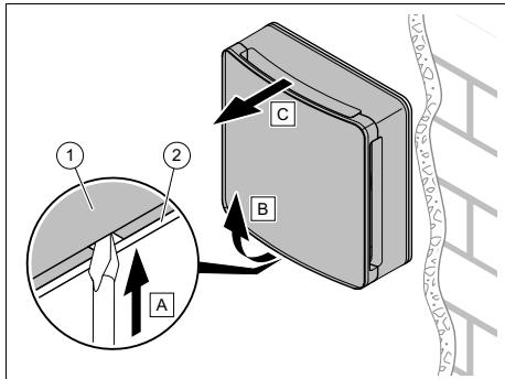
3. Démontez l'unité de ventilation (1) du cadre de fixation murale (2) (avec le brise-vent et le panneau avant).
