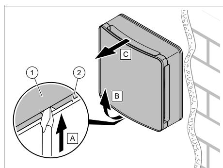
3. Smontare l'unità di ventilazione (1) (con protezione antivento e mascherina frontale) dal telaio di fissaggio a parete (2).
