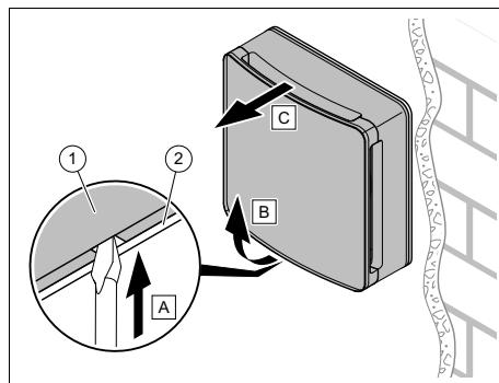
3. Demontirajte jedinicu ventilatora (1) (sa zaštitom od vjetra i čeonom zavjesom) s okvira za pričvršćivanje na zid (2).
