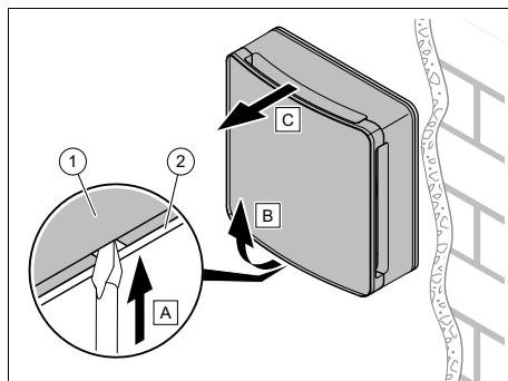
3. Szerelje le a ventilátoregységet (1) (a szélvédővel és az elülső burkolattal együtt) a készüléktartó keretről (2).
