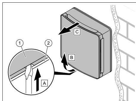
3. Demontieren Sie die Lüftereinheit (1) (mit Windschutz und Frontblende) vom Wandbefestigungsrahmen (2).
