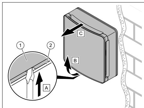
3. 请将风机单元 (1) (连同防风装置和前挡板) 从墙壁固定框架 (2) 上拆下。
