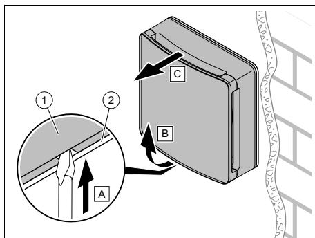
3. Demontujte jednotku ventilátoru (1) (s ochranou před větrem a předním panelem) z nástenného upevňovacího rámu (2).
