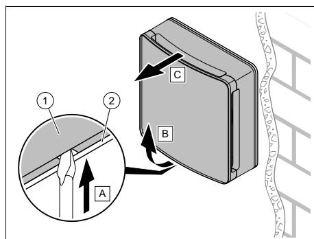
3. Desmonte a unidade de ventilador (1) (com a proteção contra vento e a guarnição dianteira) da estrutura de fixação na parede (2).
