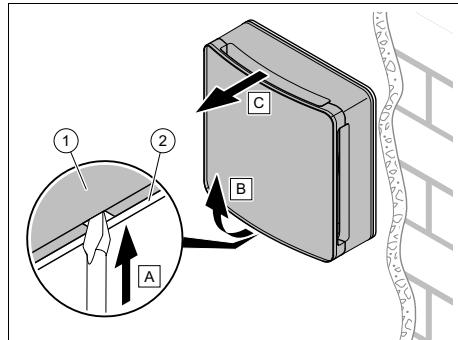
3. Jednotku ventilátora (1) (s ochranou proti vetru a čelným krytom) demonštujte z rámu upevnenia na stenu (2).
