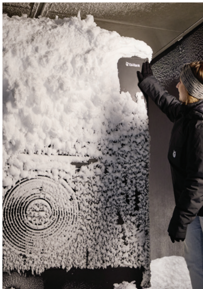
Klimatická komora pro simulaci různých ročních období
