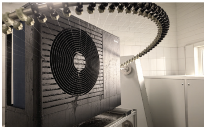
Test odolnosti proti stříkající vodě pro ochranu i při extrémních srážkách
