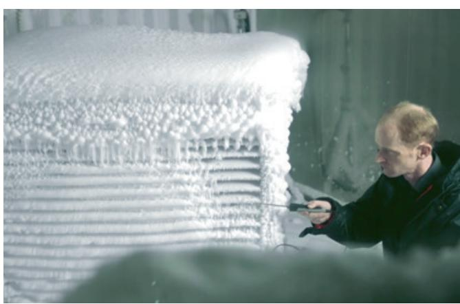
Testování jednotky v extrémních klimatických podmínkách v chladicí komoře.
