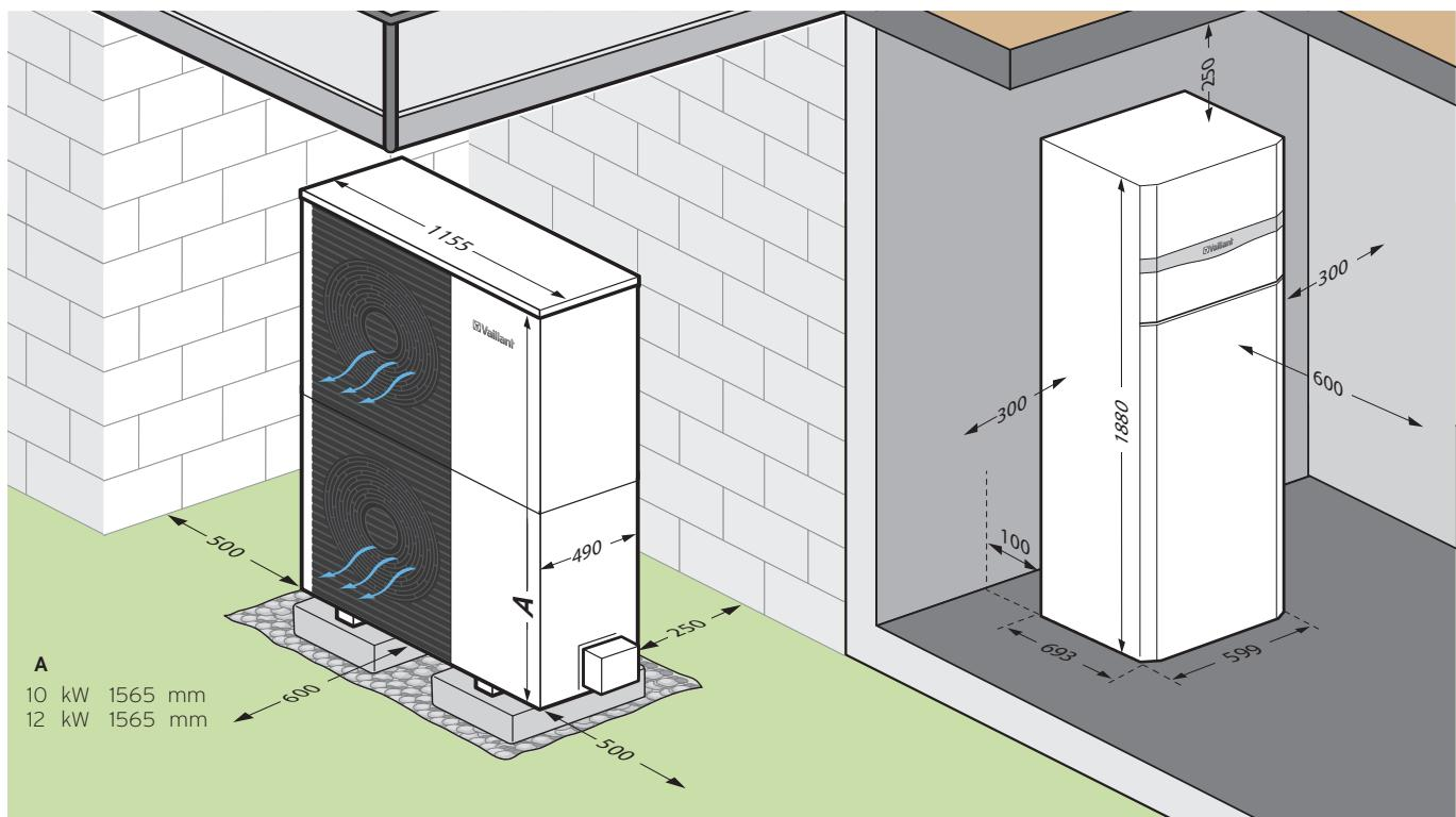
Systém aroTHERM split je složen ze dvou součástí - z venku umístěného tepelného čerpadla a vnitřní jednotky.
